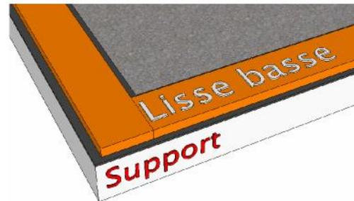
La semelle basse se pose sous tout linéaire de SANOMUR. Il convient de privilégier au maximum sa continuité et d'éviter les coupes intermédiaires. **Les faces intérieures des panneaux étant alignées au nu intérieur des semelles basses**, une attention particulière doit être attachée à la pose de la semelle basse de manière à éviter tout décalage.
